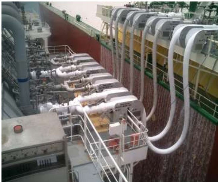
コンポジットホースを使用し、 船舶間でのL N G移送を行う
