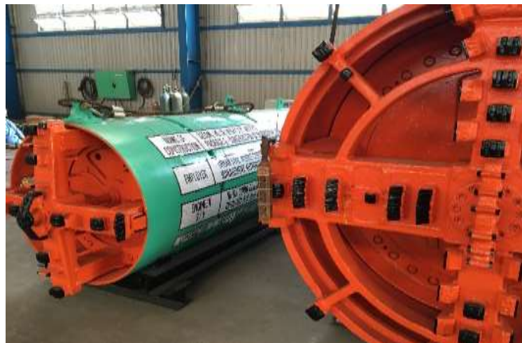
推進機（下水道掘削に使用）
