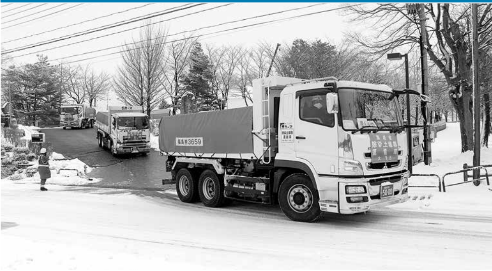
福島県泉崎村のさつき運動公園陸上競技場の仮置場から出発する同協組所属の大型ダンプトラック。2台での隊列走行を基本とし、大熊町の中間貯蔵施設を目指す
