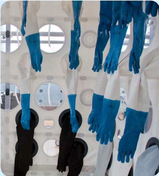
グローブを用いて、テント内の廃棄対象物を分解したり、解体することができます。放出された汚染物質は、テントのフィルムによって効果的に包囲されます。
